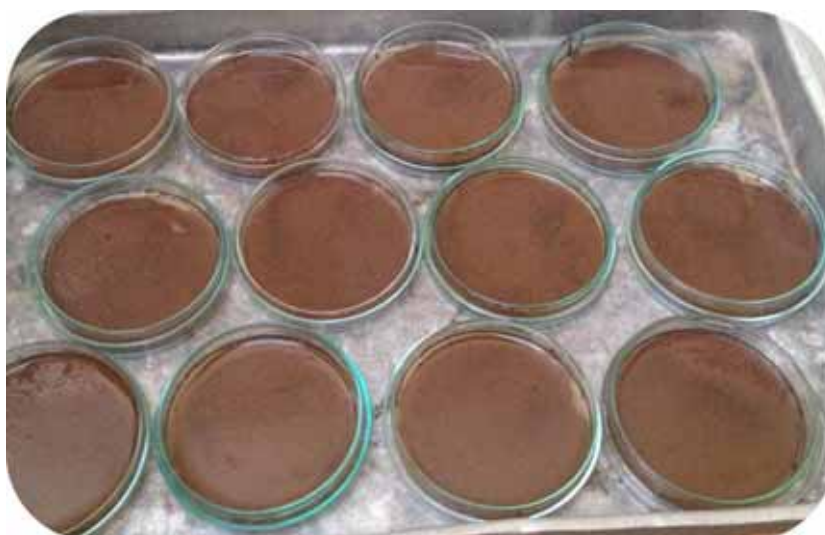
Figura 12: Placas de Petri contendo 20g de solo enriquecido com 50 \text{ mg.L}^{-1} de diuron para testes de microcosmo.
