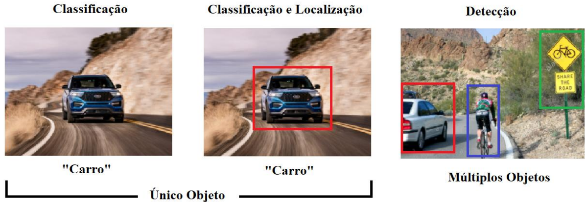
Figura 33 - Diferença entre classificação, localização e detecção de objetos
