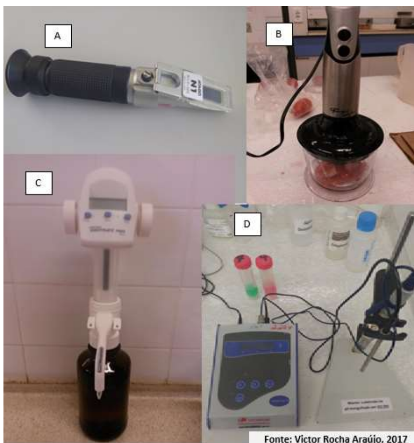
Figura 9. Refratômetro (A); Mixer para obtenção da polpa de tomate (B); Titulador (C); pHmetro (D).
