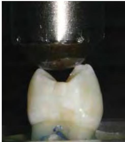
Figura 14 – Dente durante o ensaio de resistência à fratura
