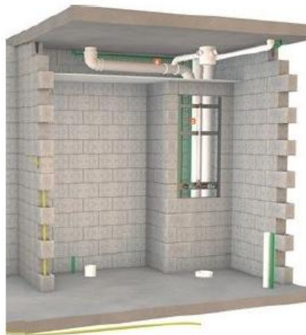
Figura 22 - Instalação hidráulica embutida na laje e shaft
