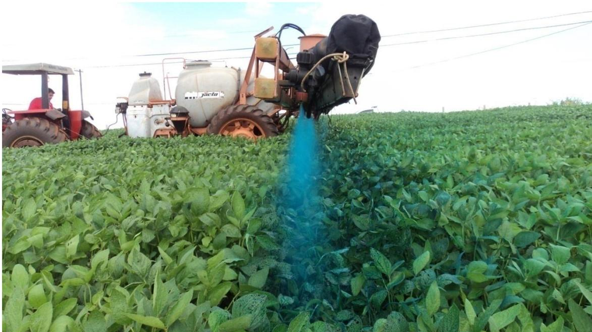
**Figura 4** - Pulverização do corante alimentício Azul Brilhante (FD&C no 1) adicionado à calda com o pulverizador Advanced Vortex 2000. Botucatu-SP, 2013.
