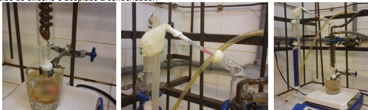
Figura 33. Balão de reação, contendo em seu interior dextrana, catalisador e anidrido acético, sobre óleo de silicone e acoplado a condensador.
