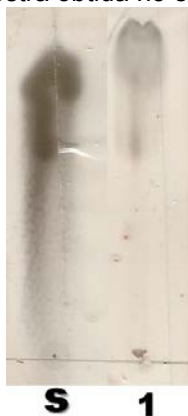
Figura 35. Análise em CCD de produto da hidrólise da dextrana FT045B com HCl em ultrassom (colunas: S = padrão de sacarose; 1 = amostra obtida no experimento 3B).
