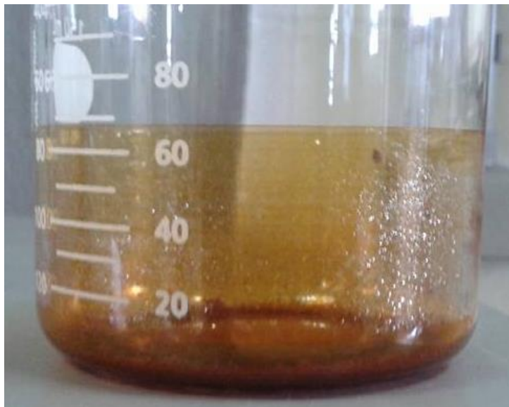
Figura 7. Formação de pequenos cristais durante a síntese assistida por micro-ondas.
