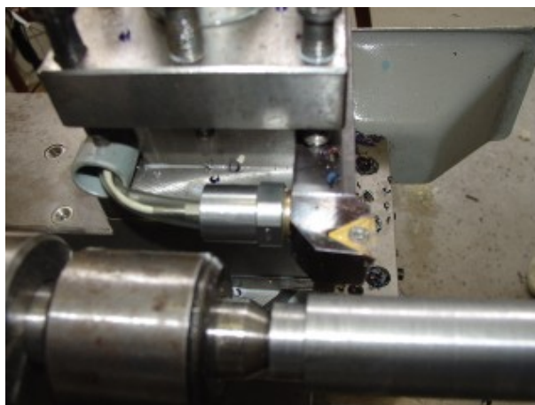
Figura 5.3 – Posicionamento do acelerômetro e do porta-ferramentas no torno.
