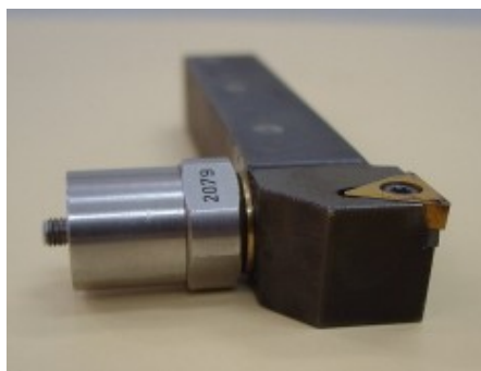
Figura 5.2 – Acelerômetro acoplado no porta-ferramenta.
