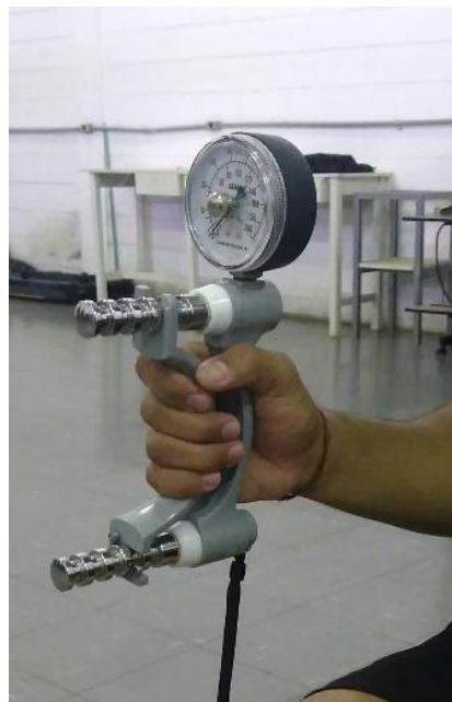
Figura 5: Foto ilustrativa do dinamômetro Jamar®, utilizado no estudo, sendo manuseado pelo participante
