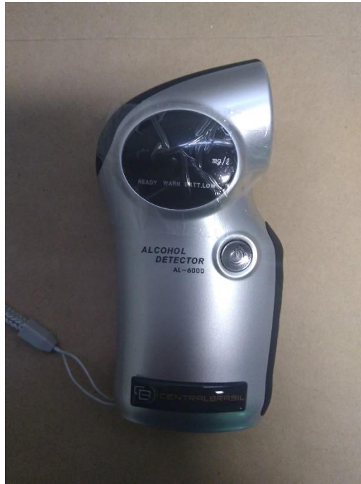
Figura 2 – Foto ilustrativa do bafômetro digital (Modelo CBAL-6000) utilizado no estudo.
