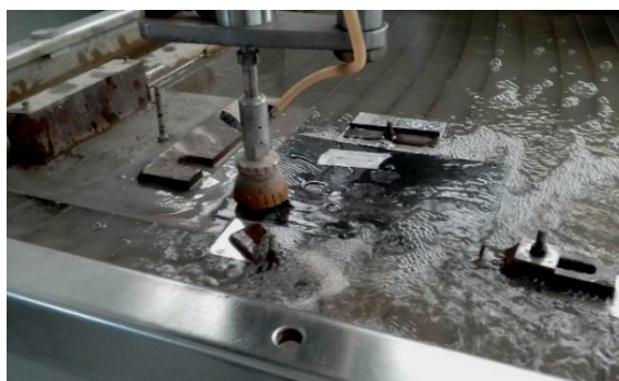
Figura 4.17 Processo de corte por jato d'água.
