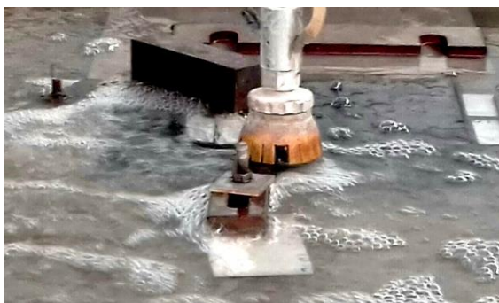
Figura 4.18 Corte por jato d'água de laminado de fibra de carbono
