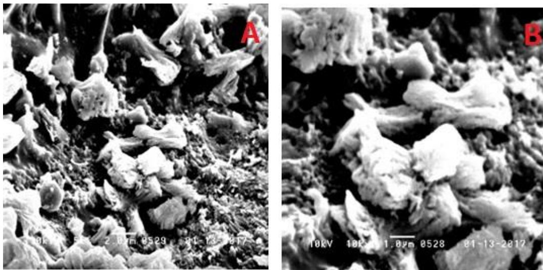
Figura 5.34 – Revestimento de carbetos de tungstênio depositado por aspersão térmica. (A) Carbetos com geometria irregular e (B) ampliação
