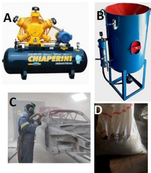
Figura 4.19 (A), compressor, (B) cilo para abrasivo, (C) operador aplicando o processo de jateamento e (D) abrasivo utilizado nos ensaios. Fonte: http://www.jatosulsp.com.br/ acesso 07/2017.
