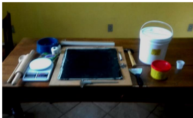
Figura 4.12 Utensílios para aplicação do revestimento a frio em laminado de fibra de carbono. Após a pesagem dos elementos, totalizando 1000 g, sendo 800 g de MECATEC 5HT e 200 g de catalisador a serem misturados eles foram acondicionados no recipiente para serem misturados até formar uma mistura homogênea. A figura 4.13 a seguir mostra a mistura já homogênea.
