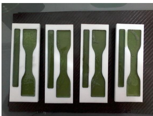
Figura 4.1 – Molde para obtenção dos corpos de prova de resinas, tanto para tração quanto flexão e corpos de prova já curados. Fonte: autor
