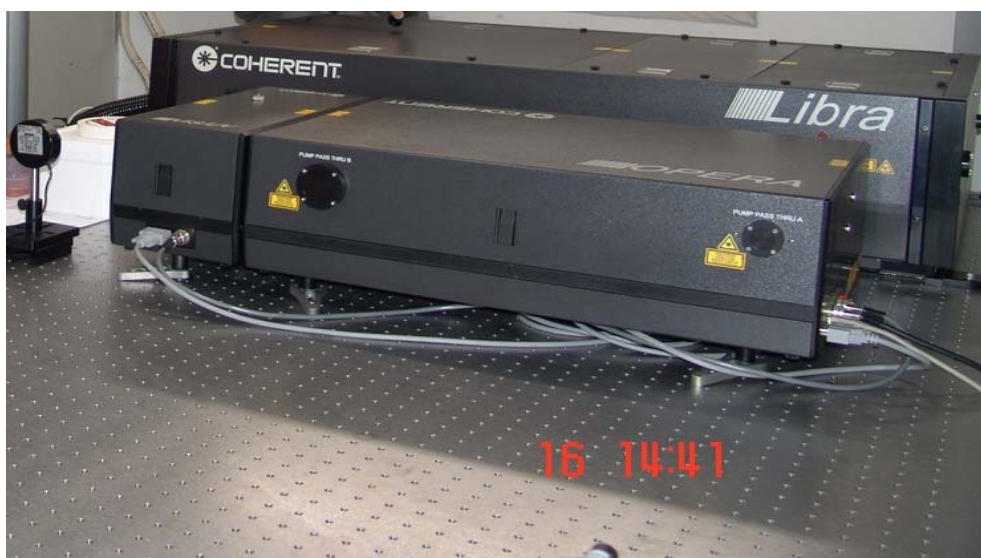
FIGURA 6 – Sistema laser de Ti:Safira (femtosssegundos)
