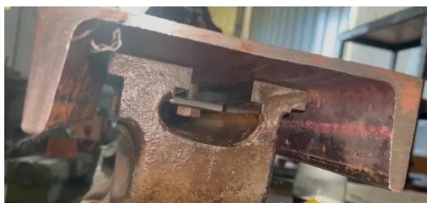
Figura 16 - Sistema de travamento no trilho
