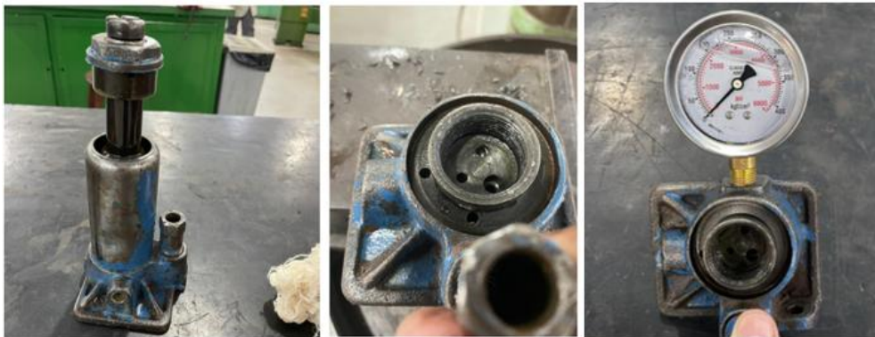
Figura 15 - Desmontagem do cilindro e furo da passagem de óleo
