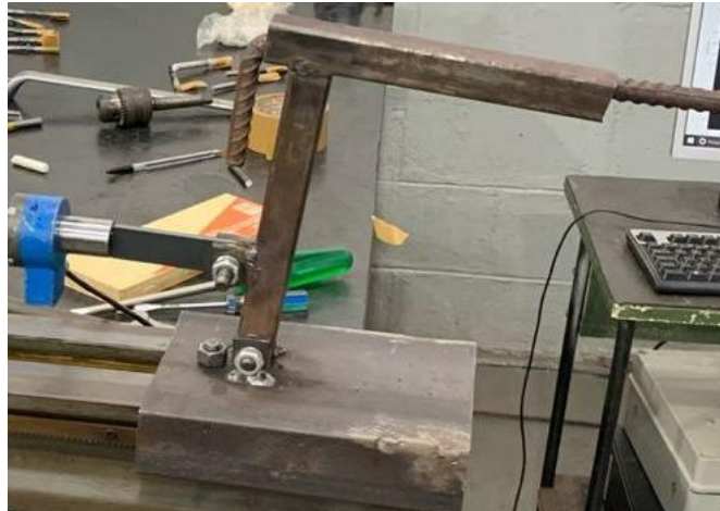
Figura 19 - Sistema de aplicação de carga montado
