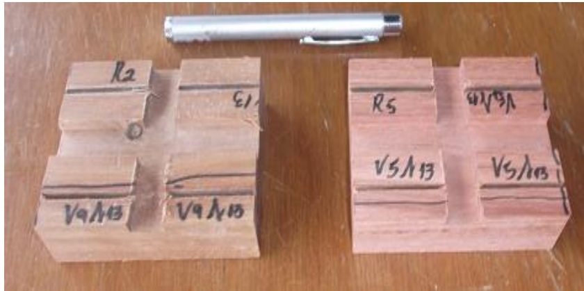
Figura 28 – Retirada dos CDP para medida de R_a , frontal.
