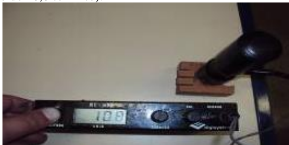
Figura 21 - Detalhe de medição da umidade em peça de madeira de Eucalyptus após secagem por ventilação forçada. (teor de umidade registrado de 10,8\% \pm 4\% ).
