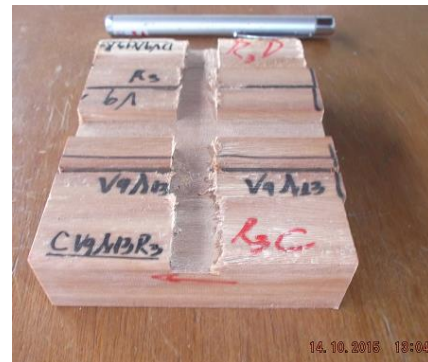
Figura 26 - a) CDPs usinados em serra seccionadora TECMATIC e b) CDP retirado.
