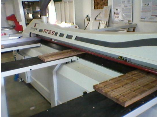
Figura 26 - a) CDPs usinados em serra seccionadora TECMATIC e b) CDP retirado.
