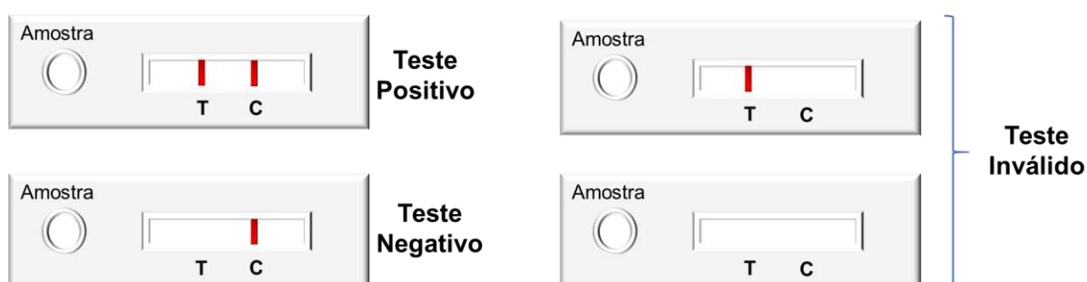
Figura 6 – Resposta visual do teste de fluxo lateral de acordo com a presença do analito (teste positivo), ausência do analito (teste negativo) ou erros durante a resposta visual (teste inválido).
