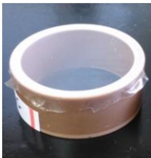
Figura 17: Membrana de composição 5 (conforme Tabela 3), contem material sensório BTF.
