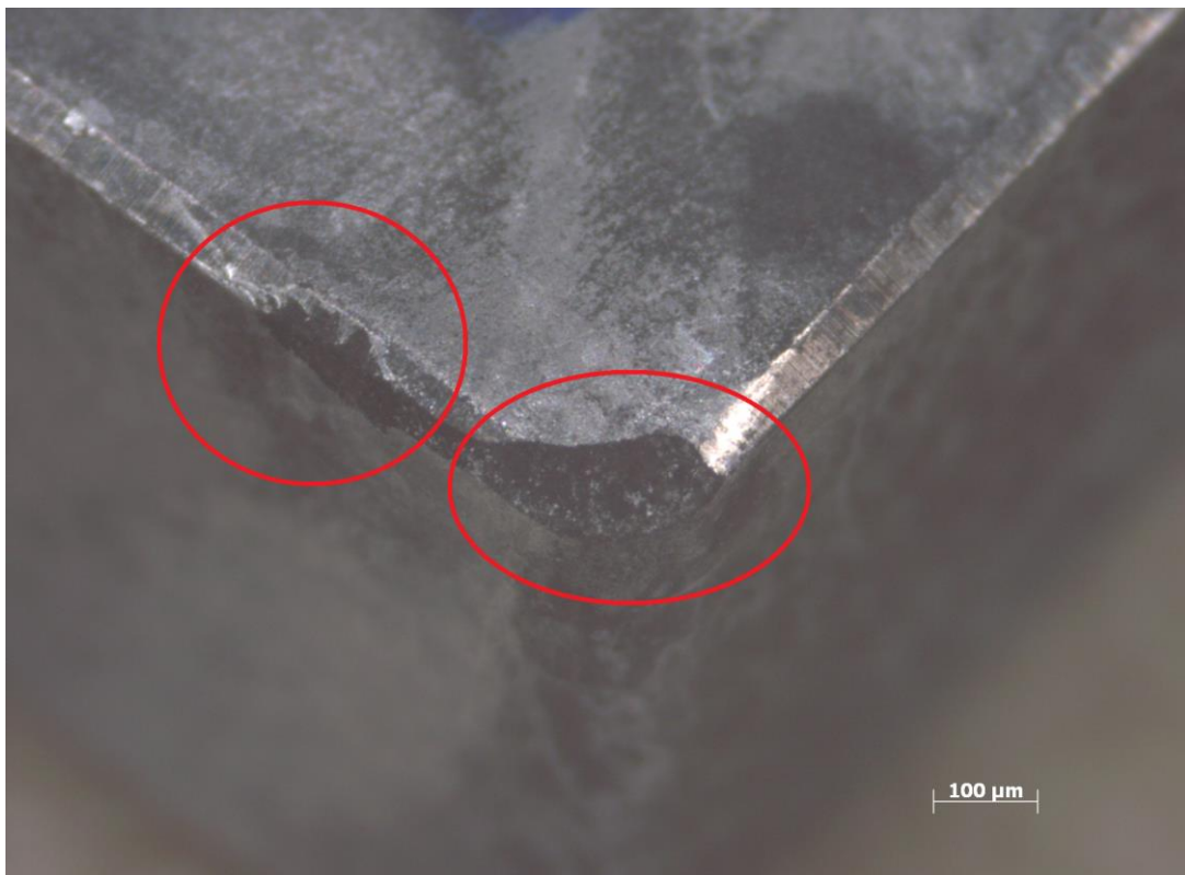
Figura 16 – Ferramenta desgastada por quebra de ponta e lascamentos.
