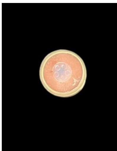
Figura 13 – Amostra de resina BPC 66 incluída em cano PVC com os tubos para ensaio de resistência adesiva
