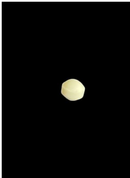
Figura 5 – Esfera de esteatita com diâmetro de 3mm
