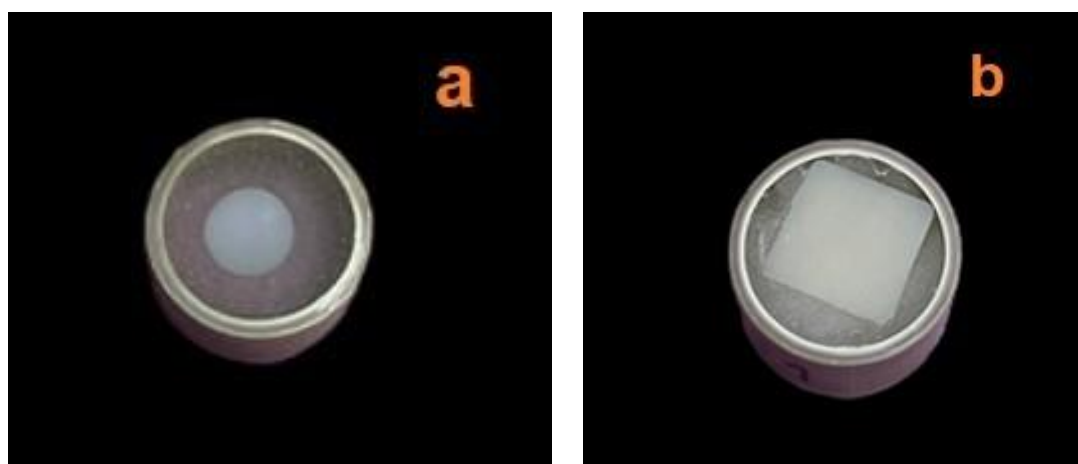
Figura 12a e b – Amostra de Resina BPC 66 e Grandio Blocs incluídas em cano PVC
