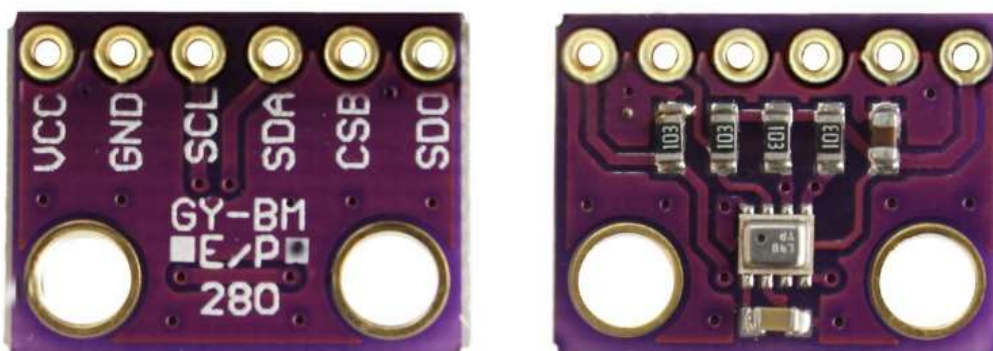
Figura 21 - Sensor BMP 280-frente e verso
