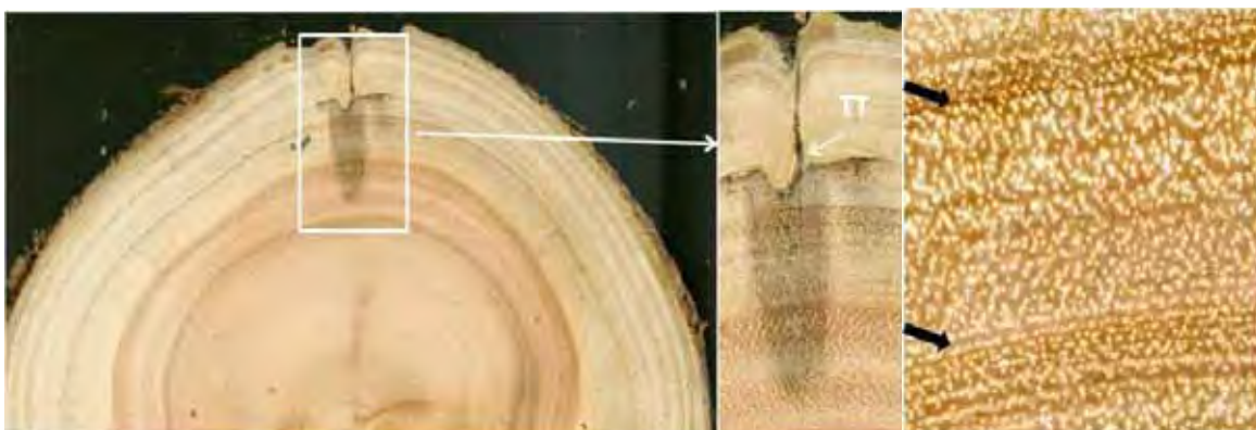
Figura 6 – Seção transversal do lenho de árvore de Eucalyptus urophylla , evidenciando os anéis de crescimento e a cicatriz no lenho induzida pela injúria na camada cambial, em decorrência da penetração da agulha do pilodyn (novembro de 2008). Fonte: Tomazello Filho e Almonacid (2011).
