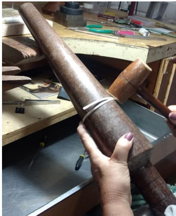
Figura 87- Processo de modelação do bracelete no tribule
