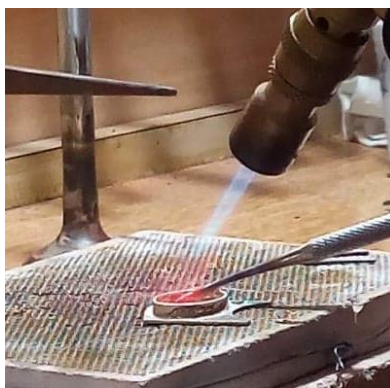
Figura 79- Processo de solda da caixinha
