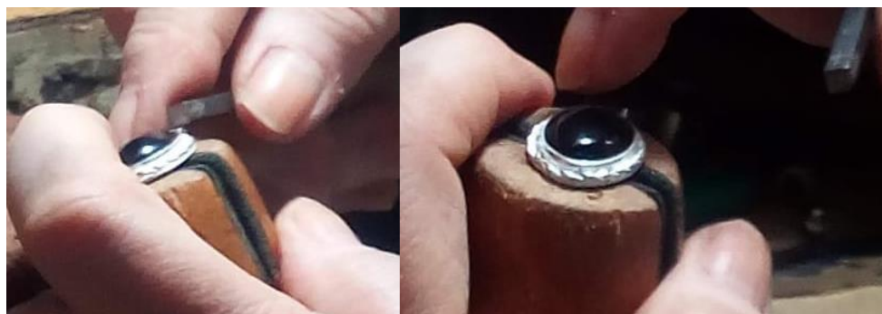
Figura 81- Processo de cravação inglesa
