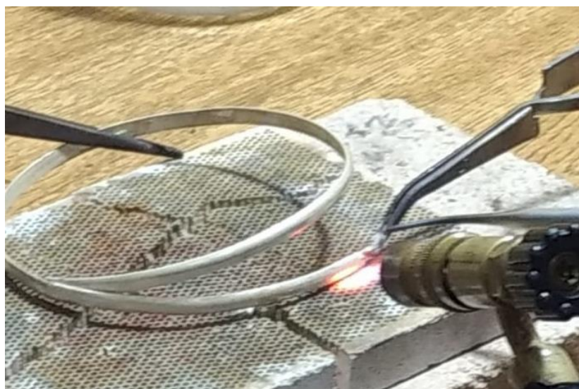
Figura 90- Processo de solda da argolinha no bracelete
