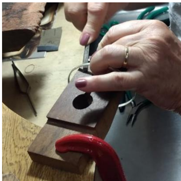
Figura 88- Processo de limar a ponta do bracelete
