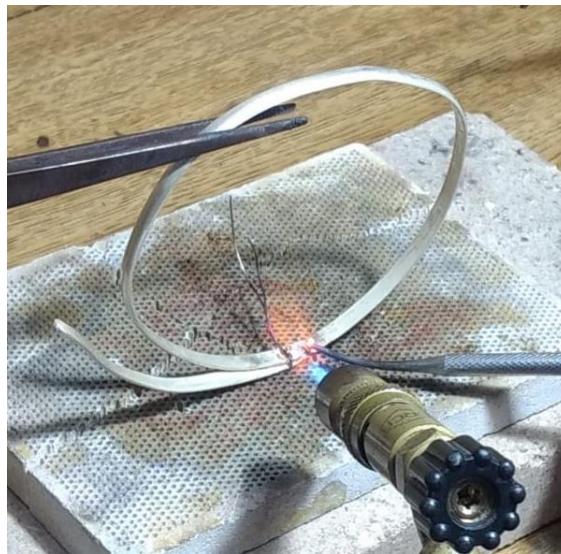
Figura 89- Processo de solda do bracelete
