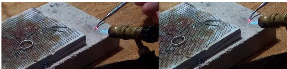
Figura 74-Processo de solda de um aro
