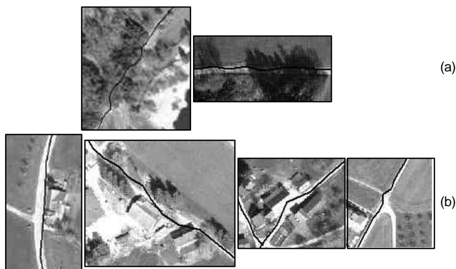
Figura 42 – Visão detalhada de alguns problemas encontrados nos eixos extraídos. (a) Problemas devido à presença de obstáculos; e (b) Problemas devido à presença de junções ou mudanças bruscas na largura da rodovia.
