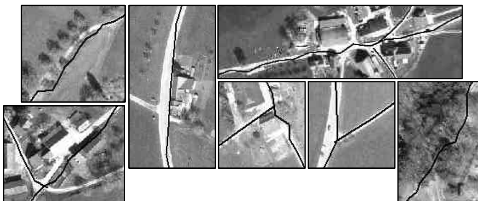
Figura 53 – Visão detalhada de alguns problemas encontrados nos eixos de rodovia extraídos.
