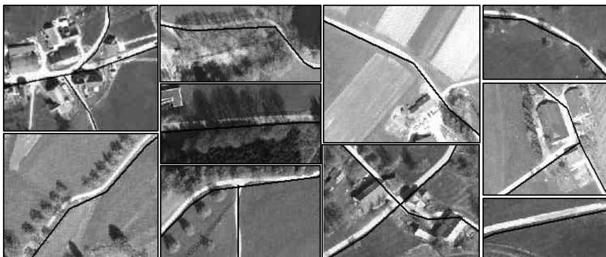
Figura 49 – Exemplos de trechos em que os eixos de rodovia iniciais se encontram fora das rodovias ou coincidentes com uma das bordas.
