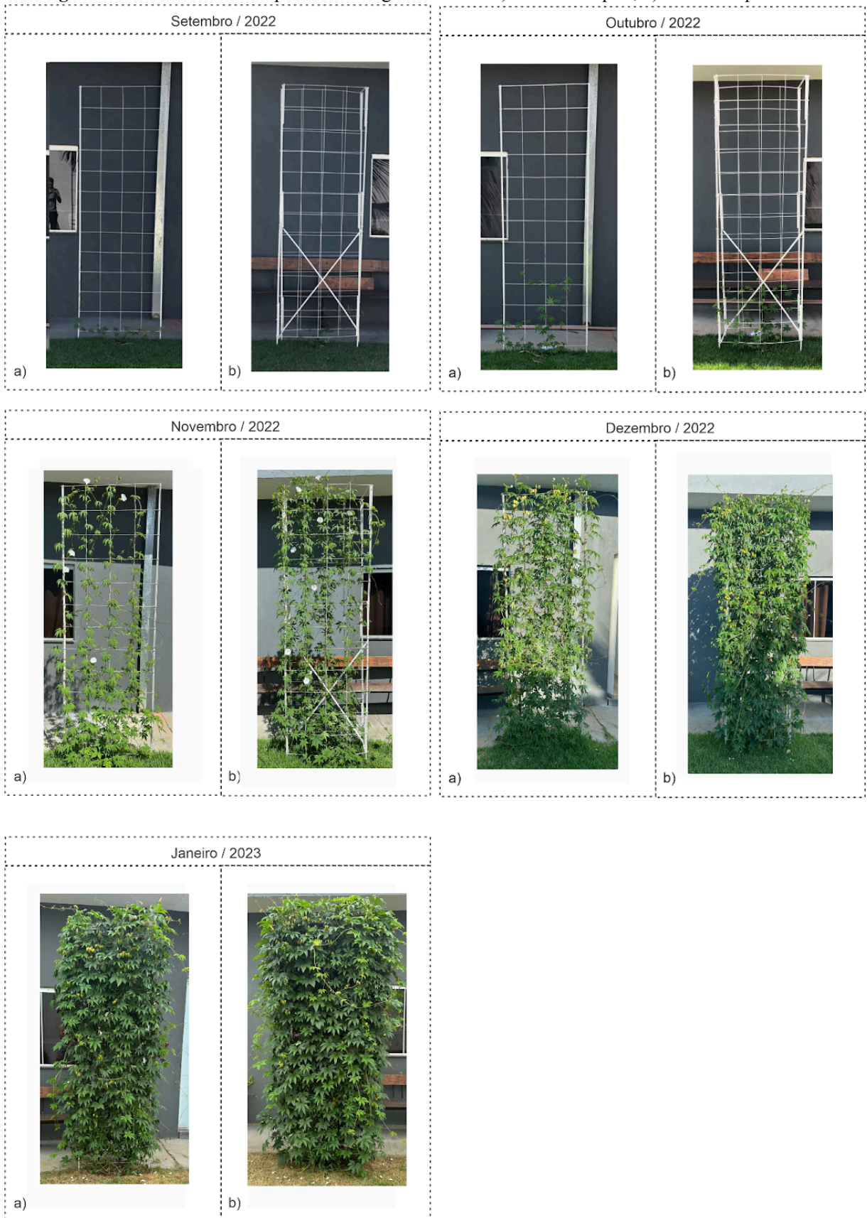
Figura 26: Crescimento da trepadeira ao longo dos meses: a) camada simples; b) camada dupla
