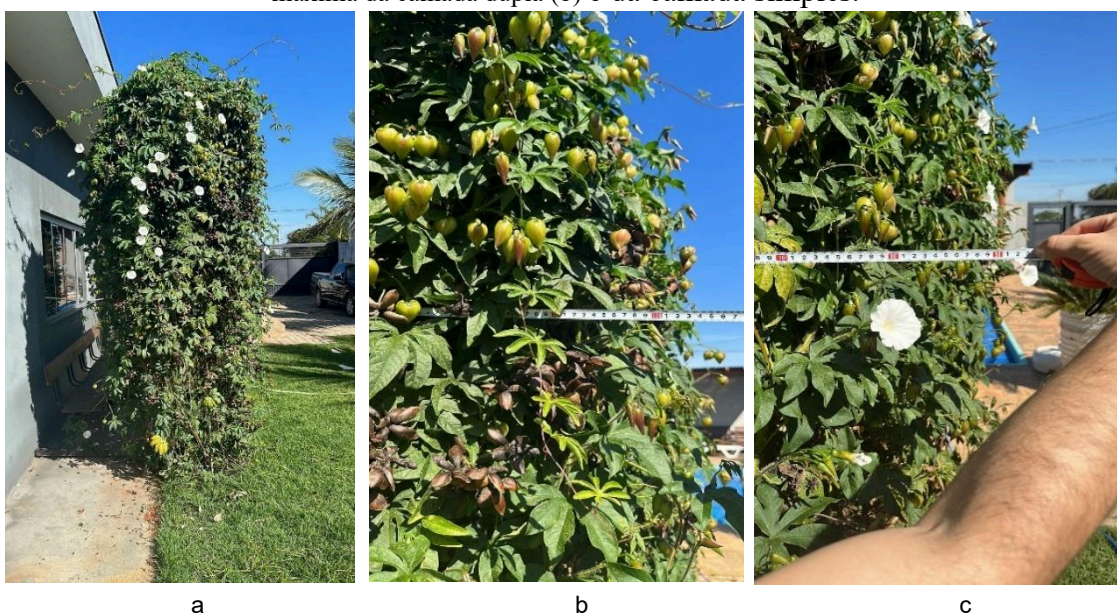
Figura 24: Imagens com a espessura da fachada verde de camada dupla (a) e das medições da espessura máxima da camada dupla (b) e da camada simples.
