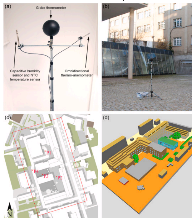
Figura 4: Geometria do modelo de validação obtida pelo software ENVI-met. (A-B) Globo utilizado para a mensuração experimental e seu posicionamento, (C) pontos de medidas do local, (D) Geometria do modelo de validação.
