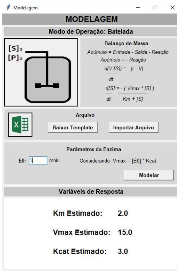
Figura 39. Modelagem realizada pelo software Enzinetics , com retorno dos valores cinéticos estimados, que conferem com os valores inicialmente simulados.
