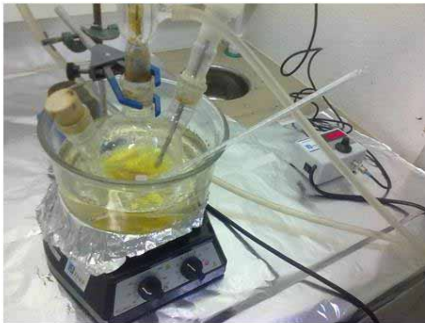
Figura 3.1 - Sistema da reação de síntese da resina fenol-furfurílica.
