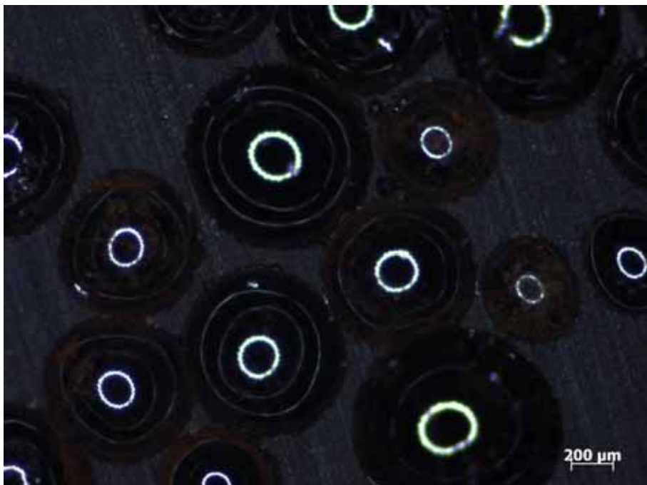
Figura 4.24 – Micrografia da amostra de FF/CNT 1% com aumento de 20x.
