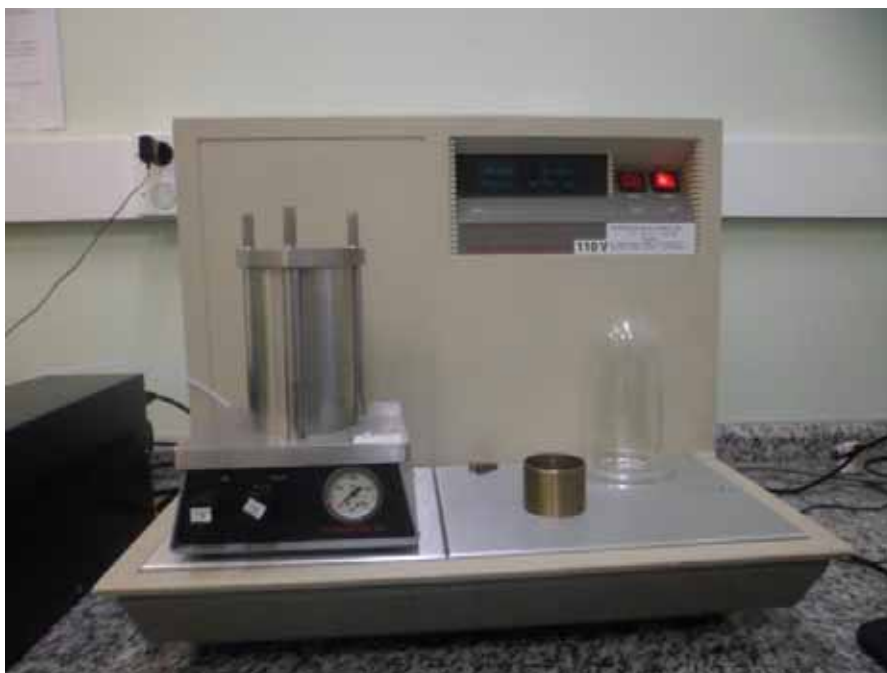
Figura 3.10 – Equipamento de DSC com acessório de célula de pressão da TA Instrument .
