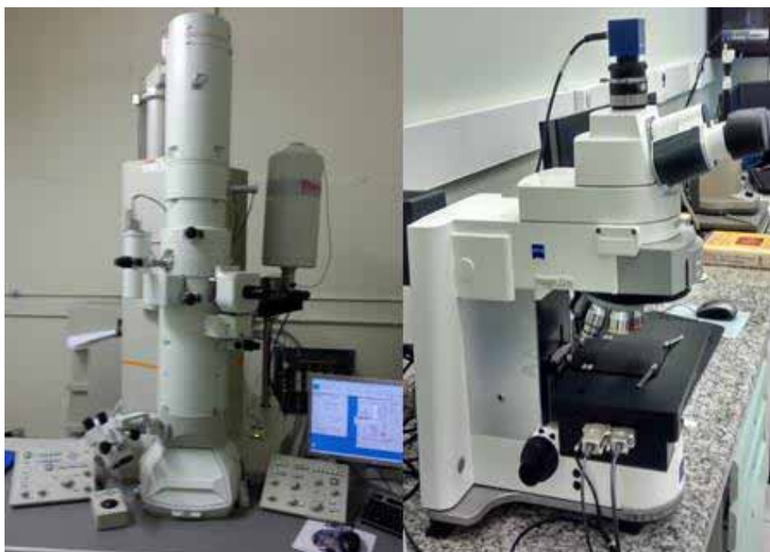
Figura 3.13 – Equipamentos de microscopia: MET a esquerda e MO a direita.
