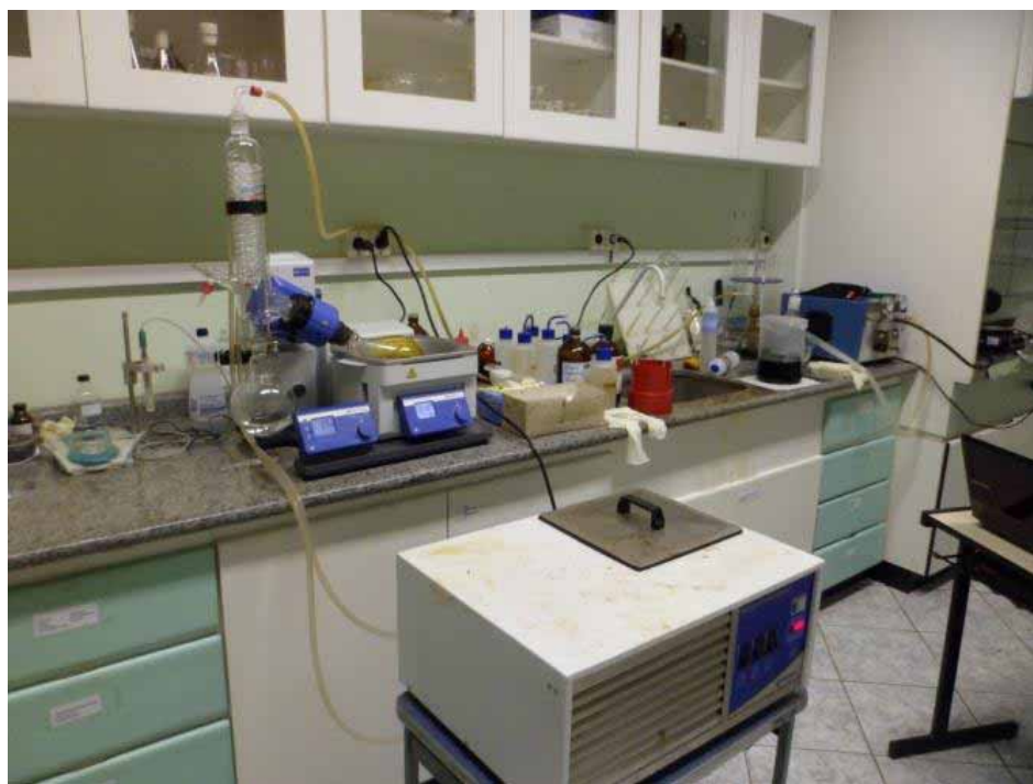
Figura 3.2 – Sistema de destilação da resina para eliminação da água residual.
