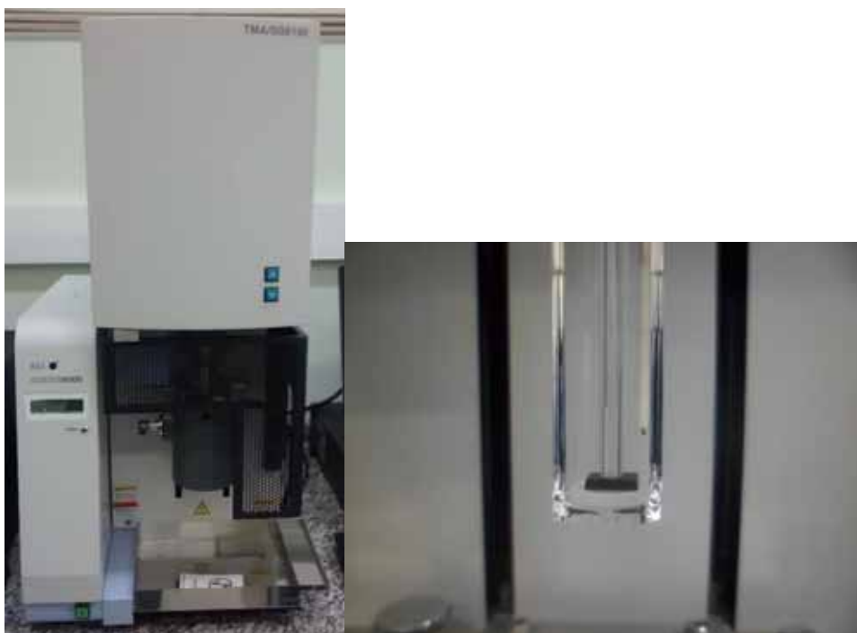
Figura 3.11 – Equipamento de TMA da SII Nanotechnology e o porta-amostra.
