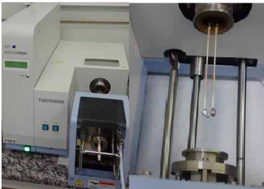
Figura 3.12 – Equipamento de TGA/DTA da SII Nanotechnology e o porta-amostra.
