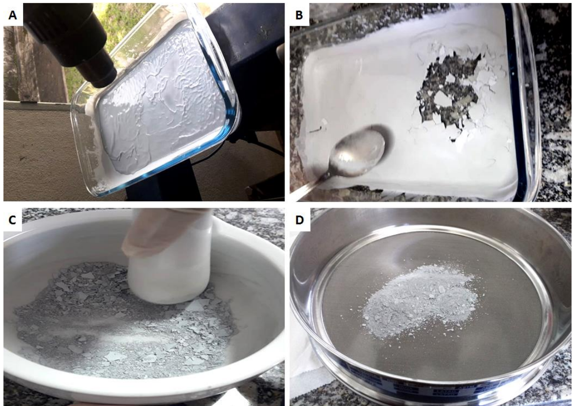
A) Processo de secagem. B) raspagem do compósito. C) mistura e moagem. D) Processo de separação.
