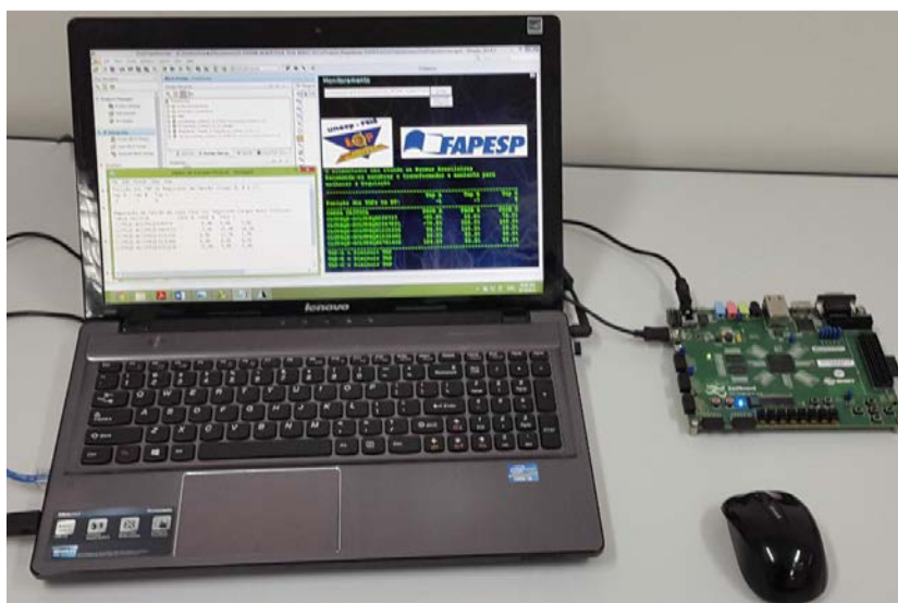
Figura 63- Montagem e funcionamento do sistema de gerenciamento da distribuição e controle (DMS&C), utilizando a placa ZedBoard Zynq™-7000 e o PC.
