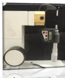
Micrômetro eletrônico digital com saída acoplado a uma base de microscópio e blocos fixados
