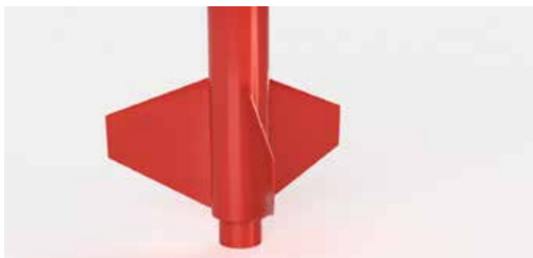
Figura 4.16 – Aleta trapezoidal com perfil de aerofólio constante
