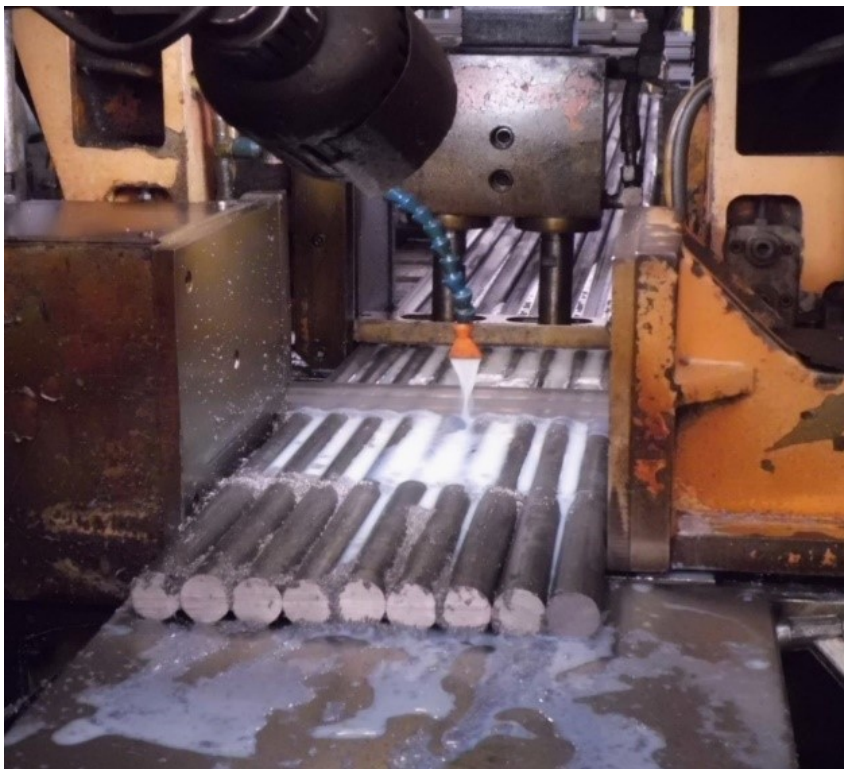
Figura 3.1: Corte de diversas barras de aço simultaneamente para posterior processo de usinagem em uma indústria metal-mecânica (SIMÕES et al., 2017).
