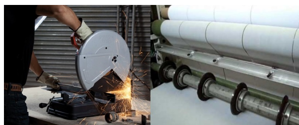
Figura 2.3: Corte utilizando serra circular e corte de bobina de papel: tempos de processamento distintos (Montagem do autor com figuras de apaixonadosporferramentas.com.br e www.promtec.com.br/ ).
