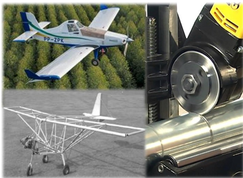
Figura 2.2: Corte de tubos para a fabricação de treliças utilizadas em aviões agrícolas: atrasos nas entregas dos itens têm grande impacto no custo da linha de montagem (Montagem do autor com figuras de www.airway.com.br ).
