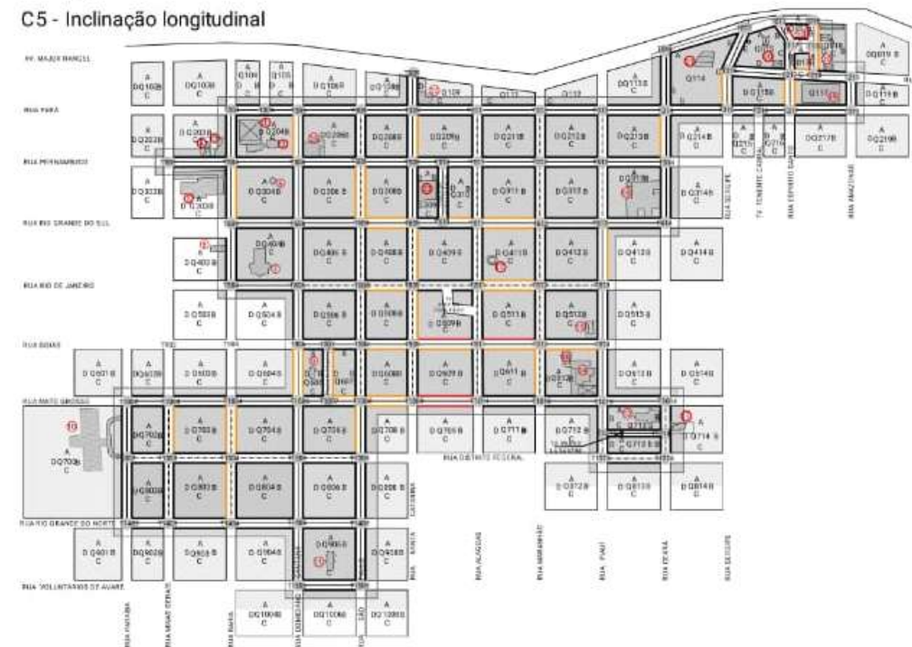
Figura 39 - Localização dos aspectos negativos do Tema Calçada no recorte espacial do centro histórico de Avaré. Mapas contendo os indicadores (C5) Inclinação longitudinal, (C6) Inclinação transversal, (C7) Desníveis e (C8) Presença de Grelhas
