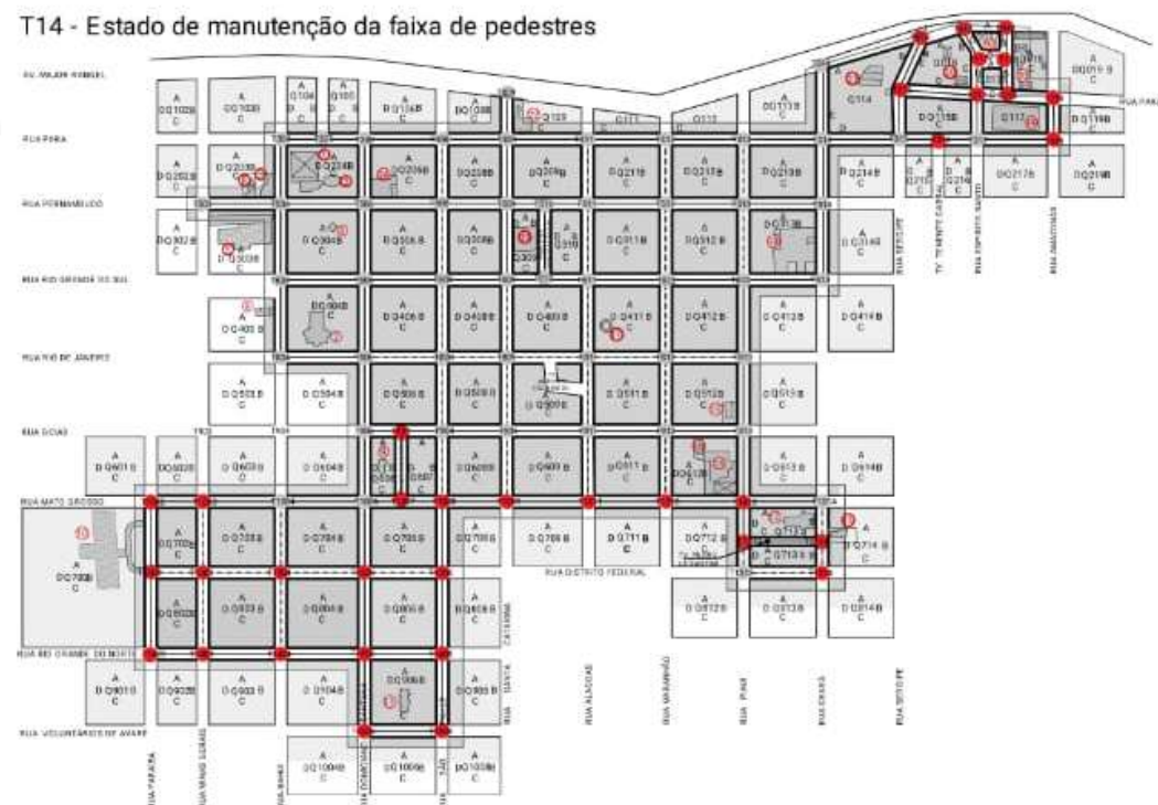
Figura 58 - Localização dos aspectos negativos do Tema Travessia no recorte espacial do centro histórico de Avaré. Mapas contendo os indicadores (T13) Largura da faixa de pedestres; (T14) Estado de manutenção da faixa de pedestres, (T15) Rebaixo de calçada, (T16) Estado de manutenção do rebaixo de calçada
