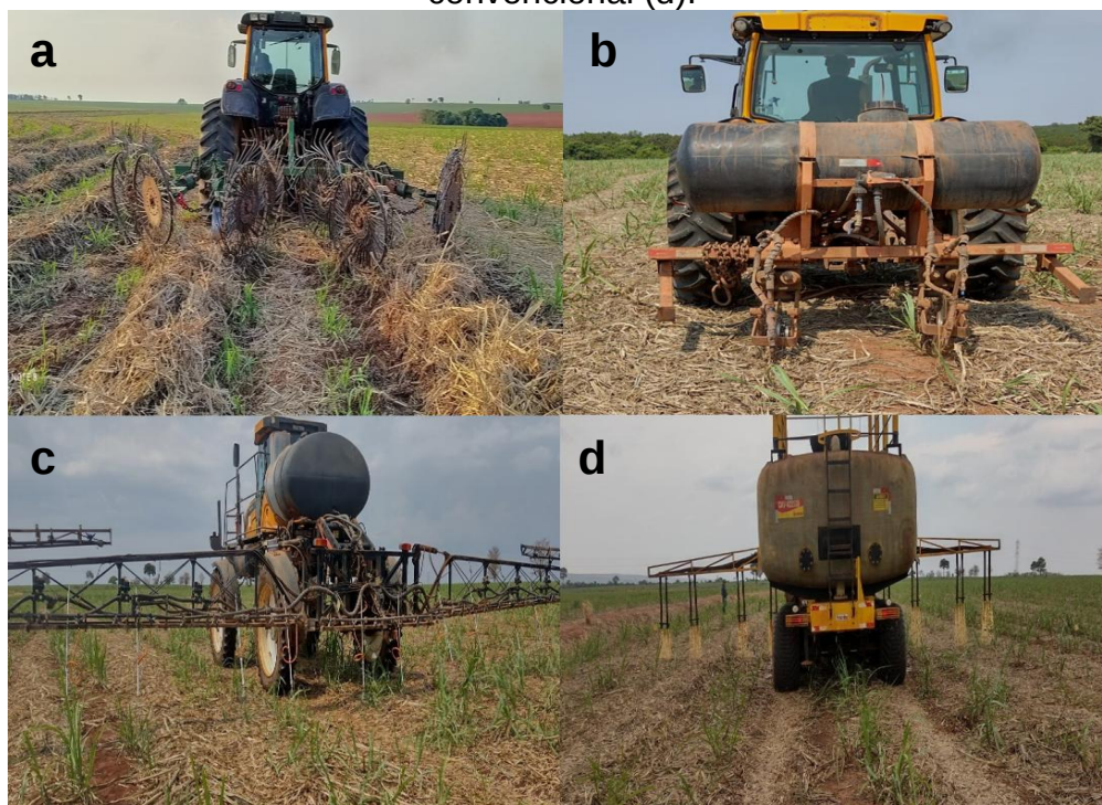
Figura 3 – Operações mecanizadas: desenleiramento (a); corte de soqueira com aplicação 70/30 (b); aplicação com pingente (c) e aplicação de vinhaça convencional (d).
