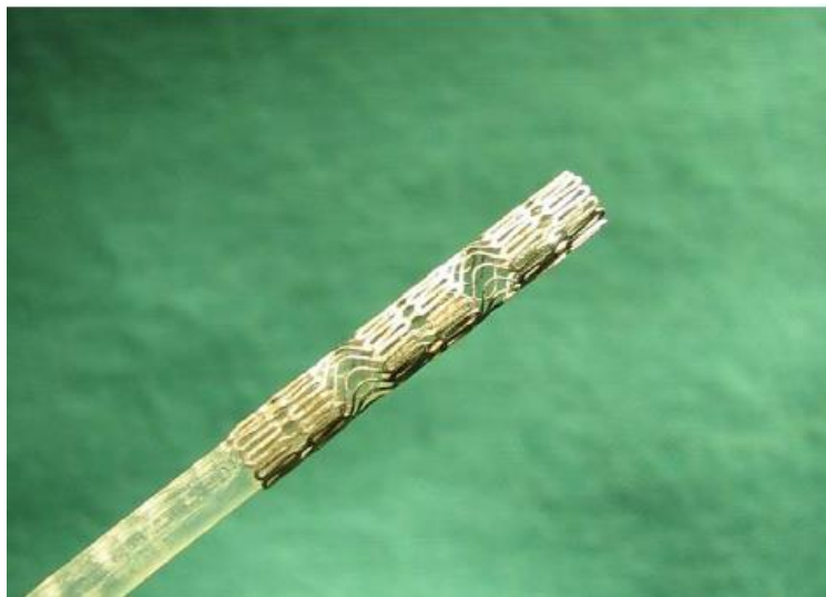
Figura 5 - Fotografia de um stent de ferro corrosível no desenho de um stent Saxx periférico (CR Bard, Tempe, AZ, EUA), após o corte a laser e eletropolimento e antes da montagem no cateter balão.
