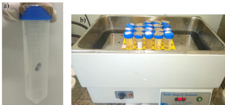
Figura 29 - (a) amostra suspensa por um fio de nylon em tubo Falcon (b) banho termostatzado mantido a 37°C por 3, 10 e 30 dias de imersão.
