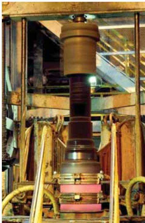
Figura 1 - Máquina de aquecimento por indução.
