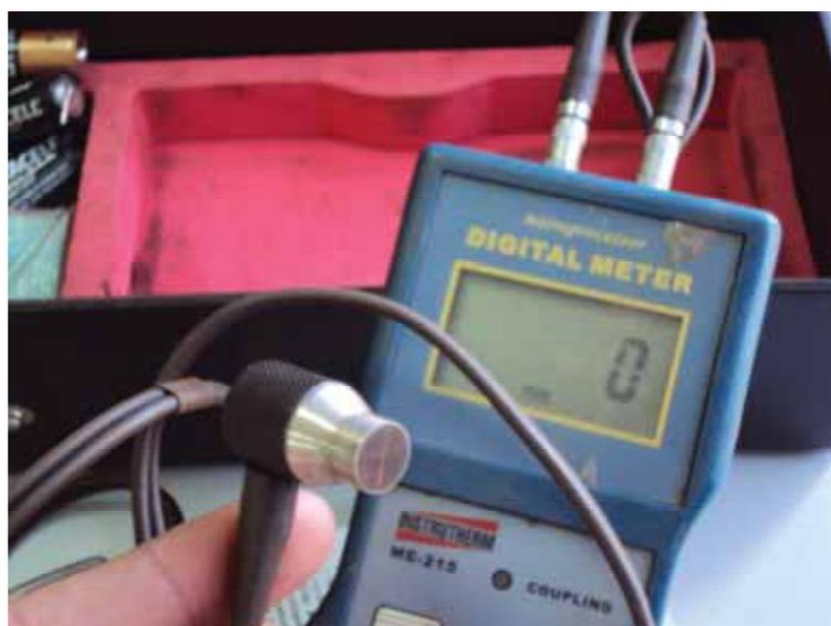
Figura 3 - Detalhe de Medidor de Espessura Digital Ultra-sônico.
