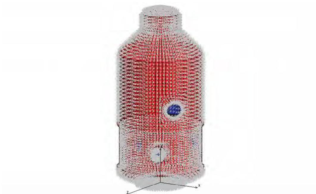
Figura 35 Aplicação de carregamento de pressão
