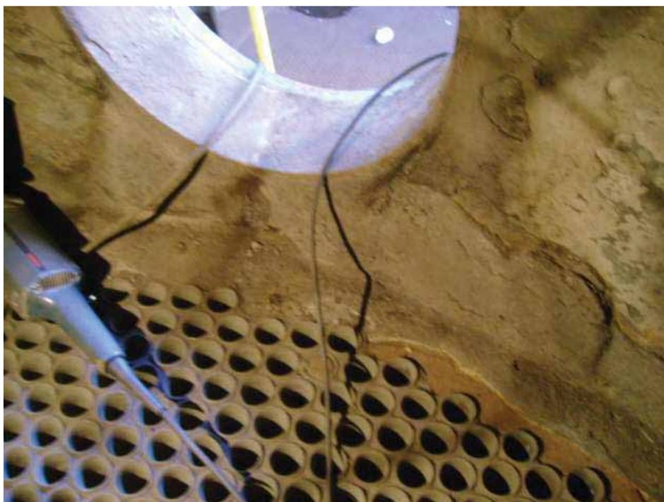
Figura 20 Medição de espessura – Região dos feixes tubulares
