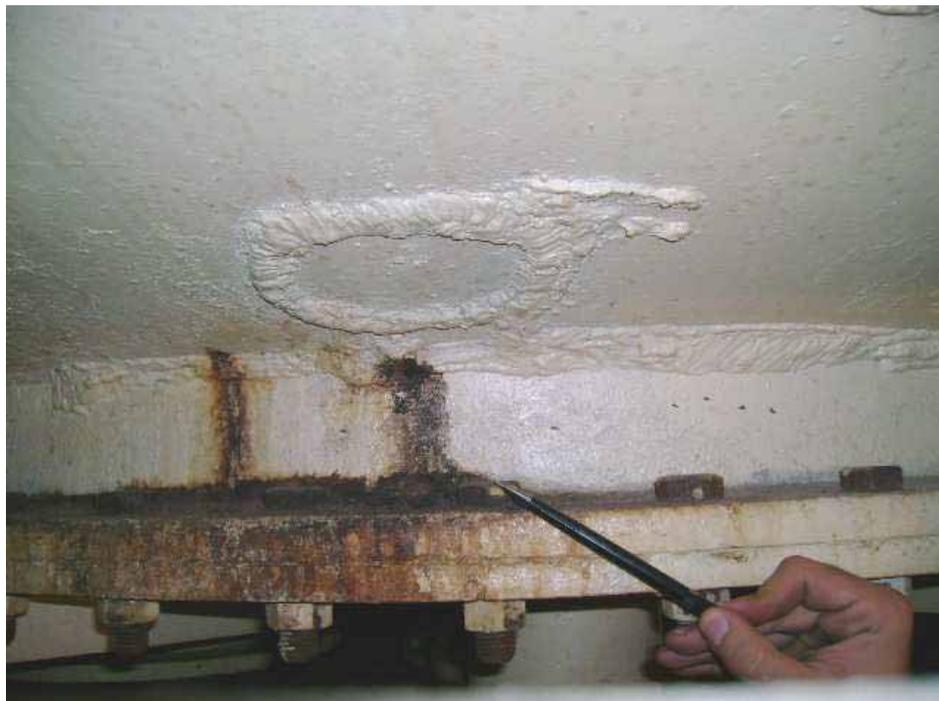
Figura 14 - Fundo do vaso – Detalhe de reparos e ruptura em solda
