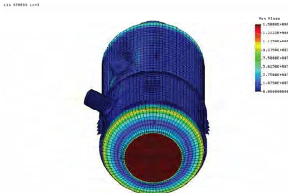
Figura 47 Detalhe de Tensões – Tampo Inferior – Limitada em 150 MPa.
