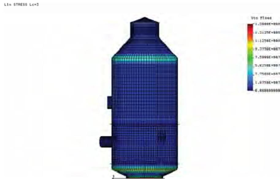
Figura 44 Detalhe de Tensões de Von Mises – Limitada em 150 MPa.
