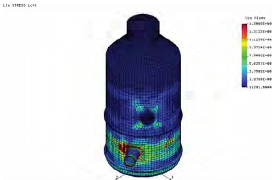
Figura 42 Tensões de Von Mises devido à temperatura aplicada.
