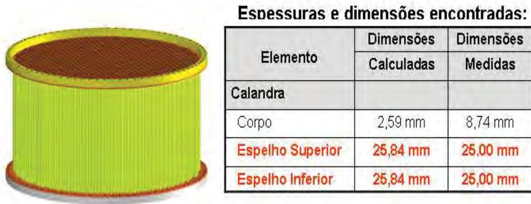
Figura 40 Dimensões de calandra – Calculadas x Medidas em Campo
