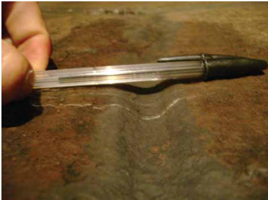
Figura 8 - Solda Longitudinal – corrosão acentuada no metal de adição
