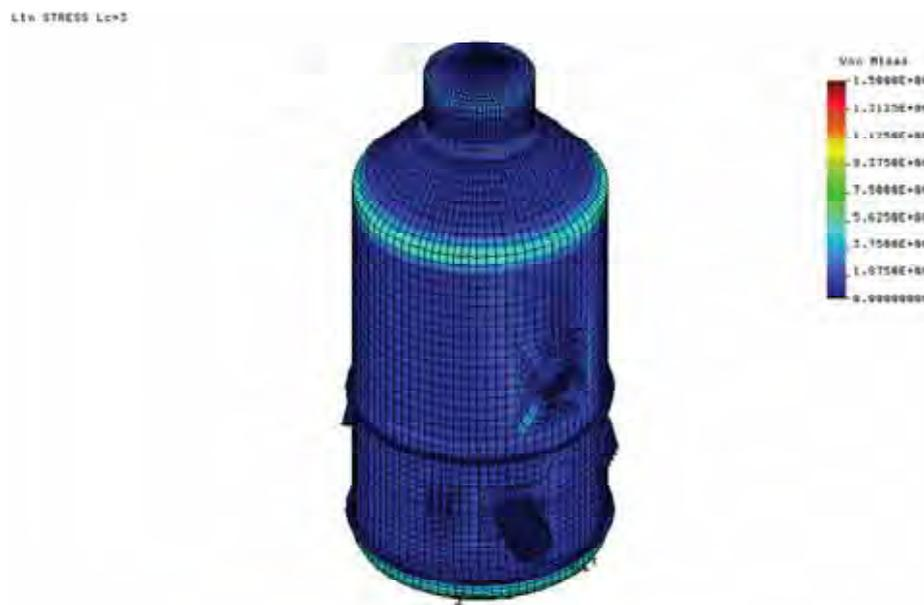
Figura 45 Detalhe de Tensões de Von Mises – Limitada em 150 MPa.
