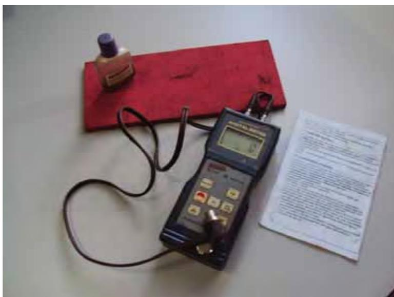
Figura 2 - Medidor de Espessura Digital Ultra-sônico.
