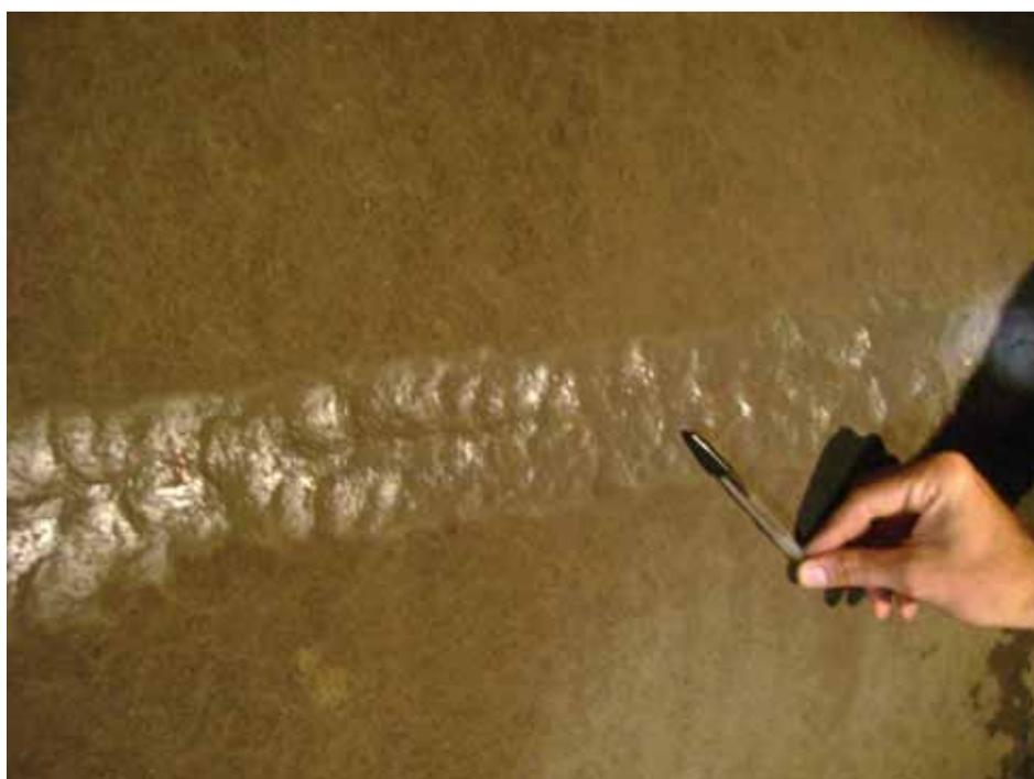
Figura 11 - Região com desgaste próxima à solda circunferencial
