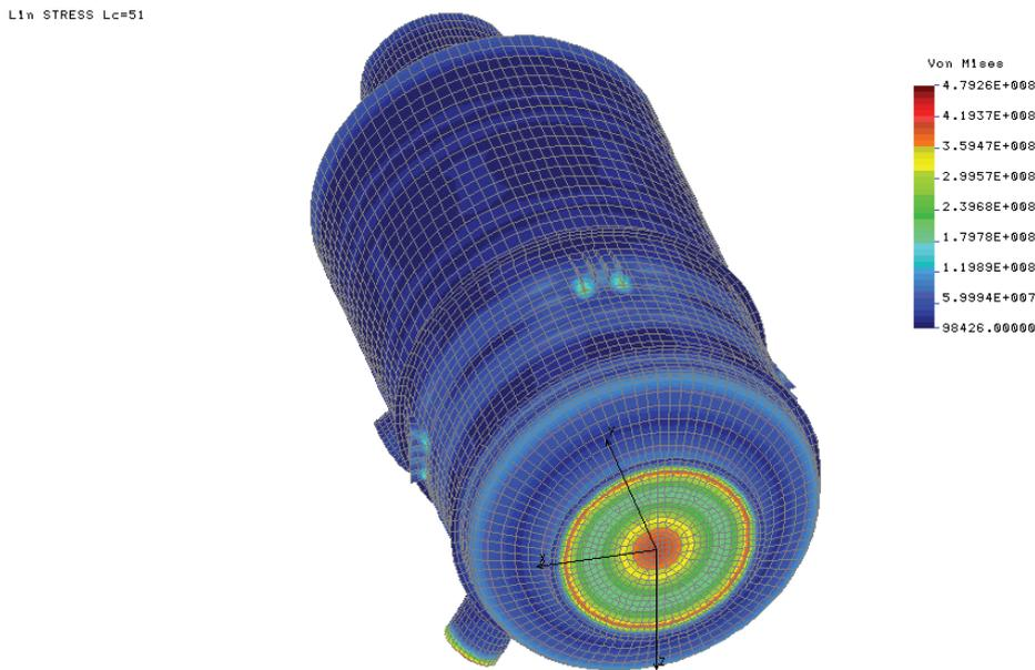
Figura 48 Resultado de Tensões – Carregamento Combinado.
