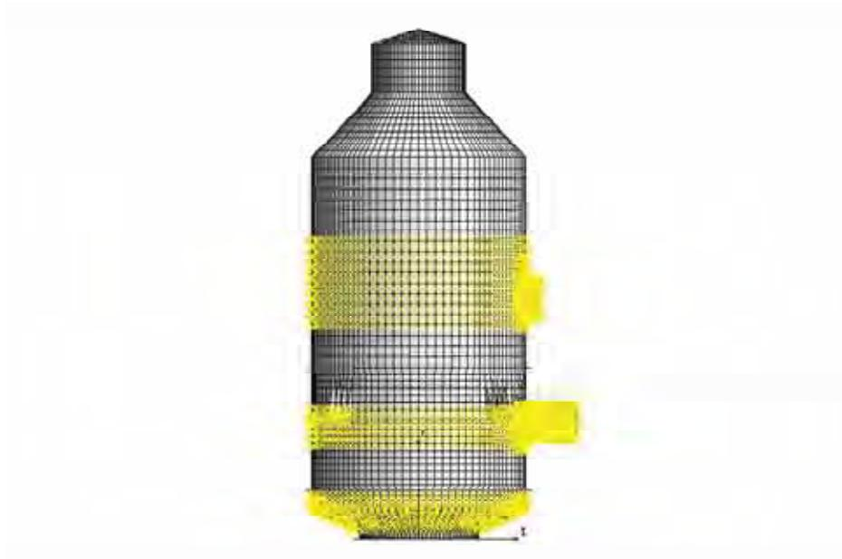
Figura 37 Aplicação de carregamento de temperatura
