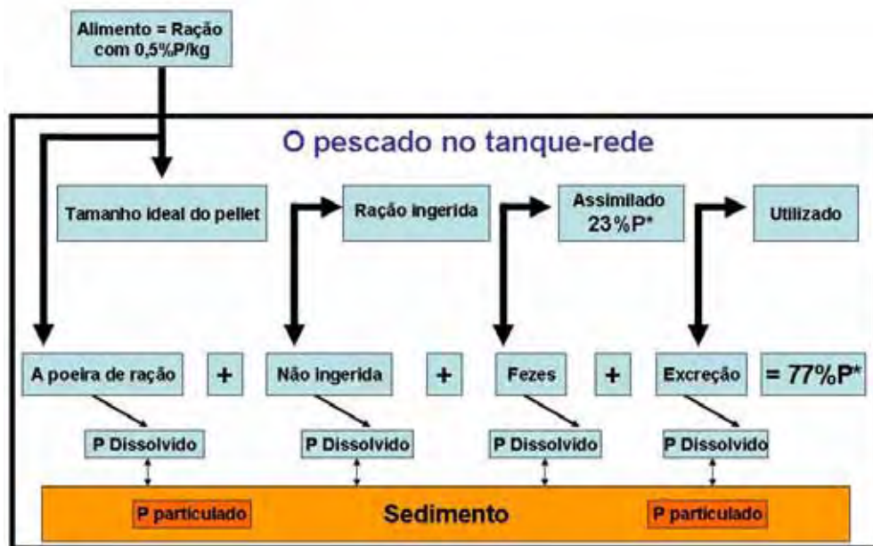
FIGURA 15 - Resumo das principais perdas de P (fósforo orgânico) para o meio aquático em decorrência da criação intensiva de peixes em tanques-rede. * = 100% do teor de P na ração (adaptado de Beveridge, 1984, in Carvalho, 2006).
