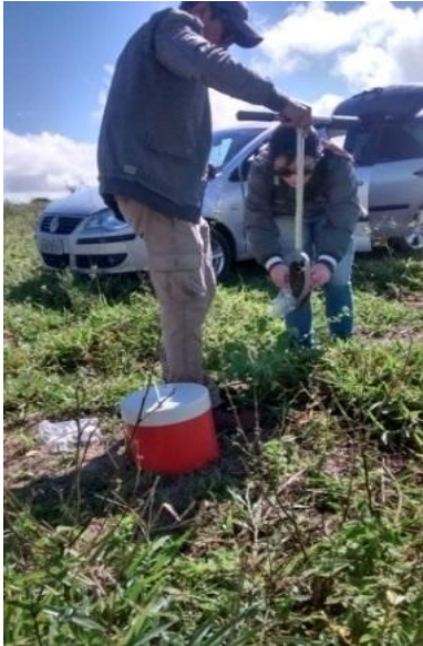
Figura 6: Coleta de amostras de solo para determinação de umidade gravimétrica
