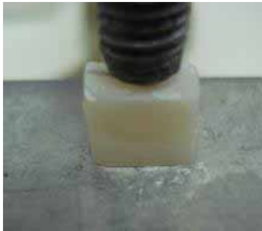
Figura 3- Dispositivo de cimentação sobre o conjunto bloco cerâmico, cimento e bloco de resina composta.
