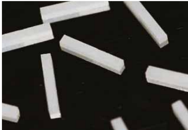
Figura 5- Palitos obtidos após o corte dos blocos cerâmica/resina.
