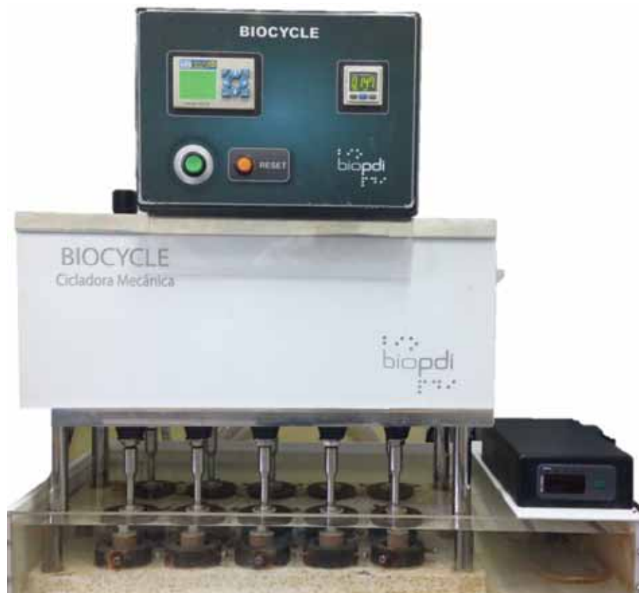
Figura 4- Cicladora de fadiga mecânica (Modelo Biocycle série BC000000108 ano 06/13, Biopdi, São Carlos, Brasil), com os corpos de prova posicionados.
