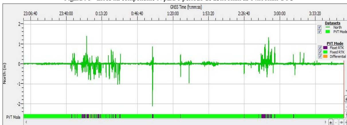
Figura 98 - Erros na componente N para o período de 23h00min as 04h00min UTC
