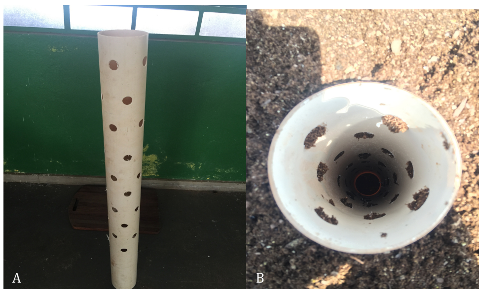
Figura 2. (A) Cano de PVC utilizado como composteira (torre de minhoca). (B) Composteira instalada no centro do tambor.
