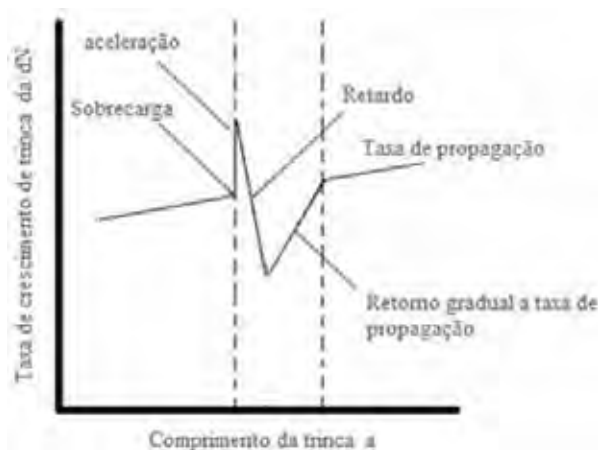
Figura 9 - Comportamento típico de uma trinca após a aplicação de uma sobrecarga (YUEN; TAHERI modificada, 2006).
