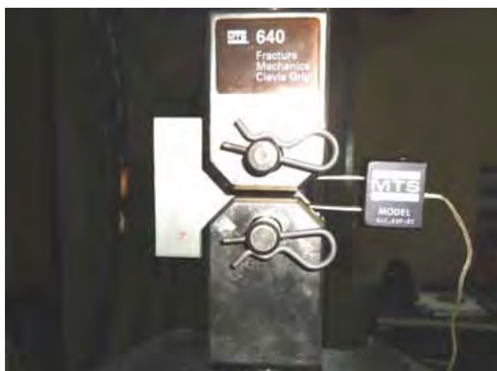
Figura 15 - Clip Gage MTS instalado no Corpo de prova (CRISTINO, 2011).
