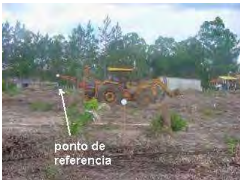
Figura 4. Imagem capturada do vídeo digital (vista lateral) do conjunto trator-pulverizador em deslocamento no campo, indicando o ponto de referência na ponta da barra.
