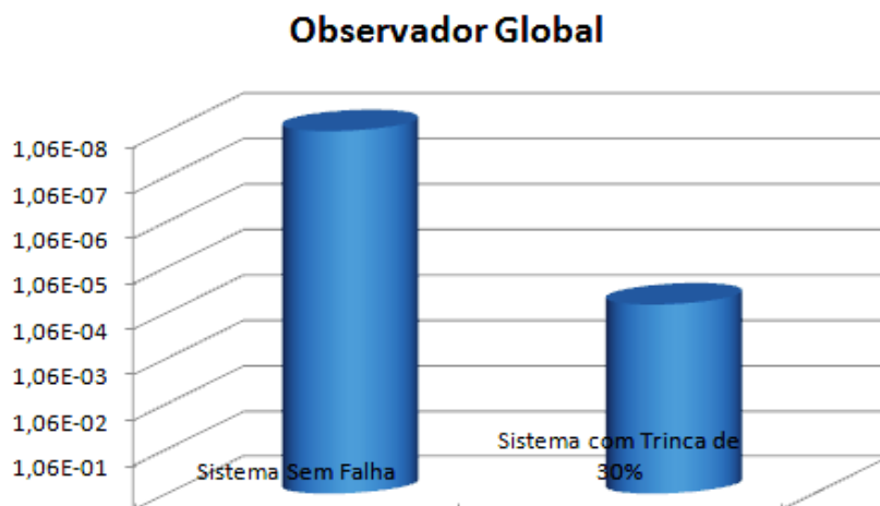
Figura 6.5 - Diferença de RMS dos valores de deslocamento do 43º grau de liberdade com o observador global.
