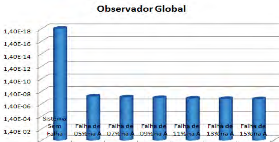
Figura 5.4 – Diferença de RMS dos valores de deslocamento do terceiro grau de liberdade com o observador global.
