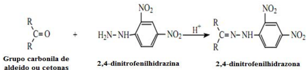
Figura 8: Reação dos grupos carbonila com 2,4-dinitrofenilhidrazina (Adaptado de ALLEN, 1943).
