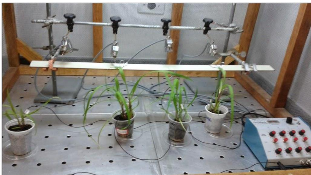
Figura 4. Equipamento EPG com quatro canais para conexão de insetos e plantas, e amplificador ao lado direito.
