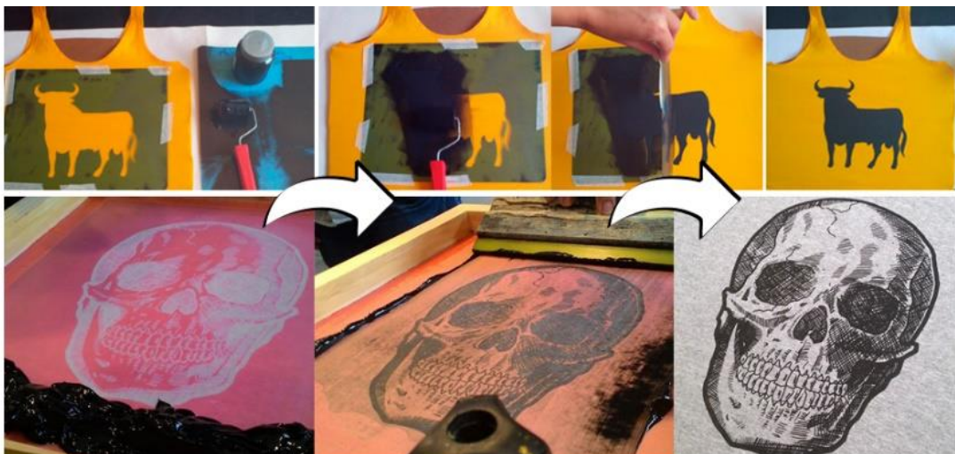
Figura 6 - Comparação entre a forma de aplicação do estêncil e da serigrafia
