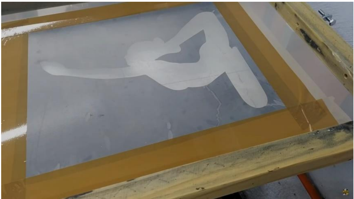
Figura 15 - Matriz já pronta para impressão, com aplicação do adesivo vinílico
