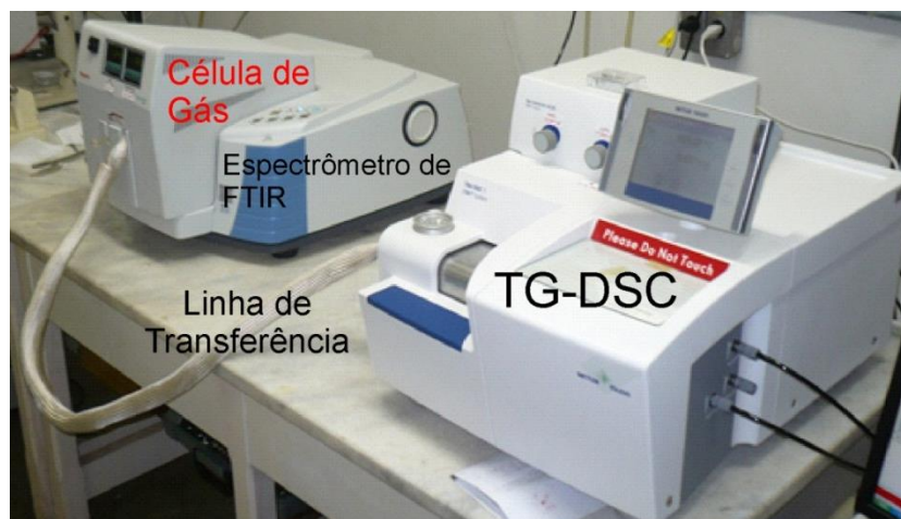
Figura 6 - Sistema TG-DSC/FTIR utilizado na identificação dos produtos gasosos.
