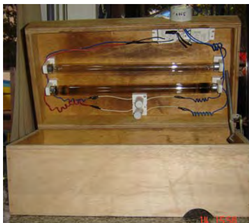
FIGURA 3.2. Sistema empregado para foto-Fenton artificial.
