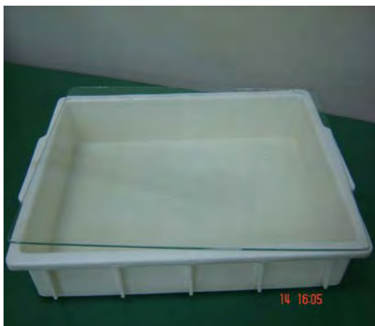
Figura 3.10 Reator empregado para degradação de 4,5 litros de resíduo.
