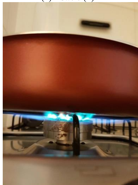
Figura 4.3 – Espalhamento de chama nos modos convencional (a) e swirl (b).
