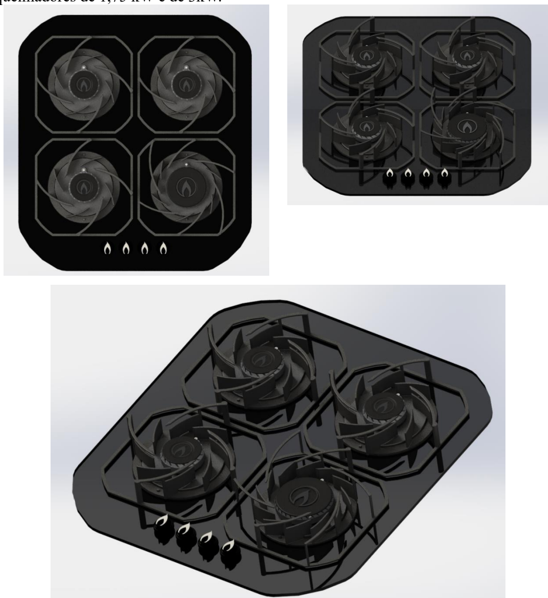
Figura A10 – Imagens renderizadas do projeto final para cooktops de quatro bocas com queimadores de 1,75 kW e de 3kW.
