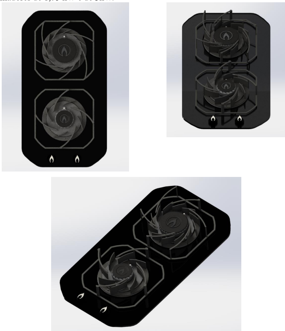
Figura A9 – Imagens renderizadas do projeto final para cooktops de duas bocas com queimadores de 1,75 kW e de 3kW.
