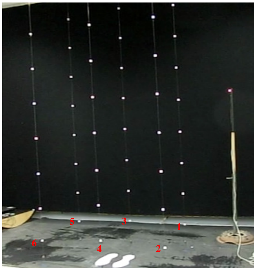
Figura 21 - Calibrador espacial: fios de prumo.
