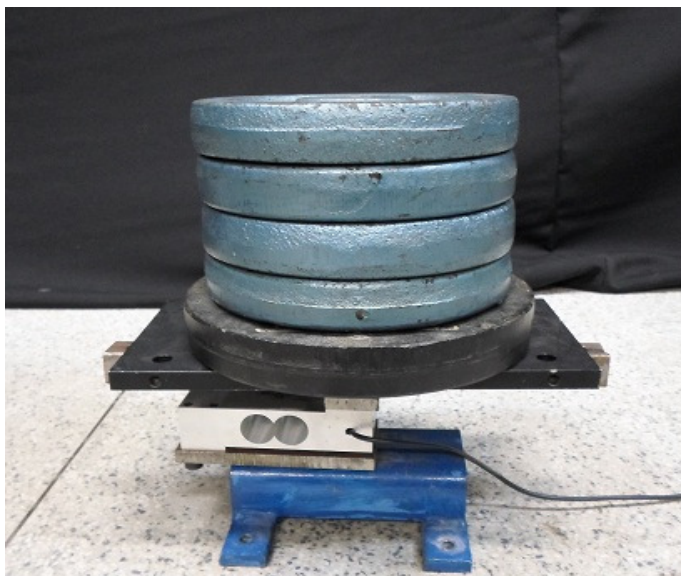
Figura 17 - Calibração da célula de carga.
